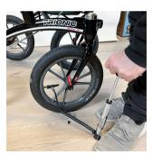
Controllare la pressione dell'aria negli pneumatici regolarmente. Trionic suggerisce una pressione delle ruote compresa fra gli 1.5 e i 2.0 bar.
