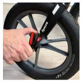
1. Aprire la leva di sgancio rapido della ruota anteriore piegandola verso l'esterno.
