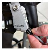
1. Se i freni non funzionano correttamente, allentare la vite posta su ogni leva (in senso antiorario) e fissarla avvitando il dado aggiuntivo verso la maniglia (in senso orario).
