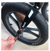
3. Chiudere la leva di sgancio rapido della ruota anteriore ripiegandola verso l'interno. Assicurarsi che la leva di sgancio rapido sia correttamente serrata, preferibilmente in posizione retrostante alla forca quando la si guarda dal senso di marcia del Walker.
