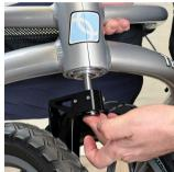
Per rimuovere l'intero sistema di sospensione delle ruote, sollevare le intelaiature spingendo contemporanemente il sistema di sospensione verso il basso.
