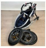
1. Agganciare le ruote posteriori agli appositi alloggiamenti dell'asse posti sul retro del telaio premendo il pulsante nero al centro della ruota e poi facendo entrare l'asse completamente nel suo alloggiamento. Rilasciare il pulsante.
