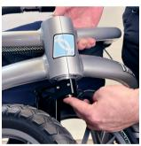
3. Fissare la sospensione della ruota anteriore alla parte inferiore e frontale del telaio nella stessa maniera, ovvero premendo il pulsante nero in fondo all'asse e spingendo l'asse all'interno del suo alloggiamento partendo dal basso. Rilasciare il pulsante.
