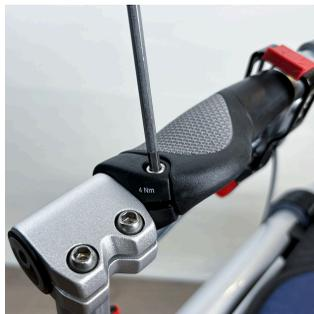
1. Allentare la vite che si trova sul retro del manico con una chiave a brugola di 4 mm.
