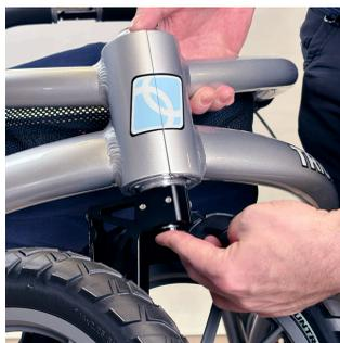
4. Assicurarsi che la ruota anteriore sia fissata correttamente sollevando il telaio da terra e spingendo la ruota verso il basso.
