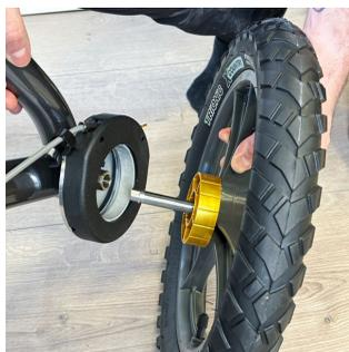
Le ruote posteriori sono removibili per agevolare il trasporto del Veloped.
