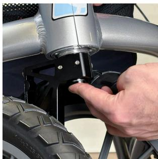
Le sospensioni della ruota anteriore sono removibili per agevolare il trasporto del Veloped.
