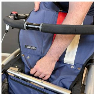
1. Tenere ferma la fodera sul lato destro, quello con la scritta Trionic. Ripiegare il lembo lungo la fodera fra il puntello telescopico e la base del sedile.
