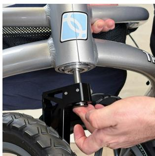
Per rimuovere l'intero sistema di sospensione delle ruote, sollevare le intelaiature spingendo contemporaneamente il sistema di sospensione verso il basso.
