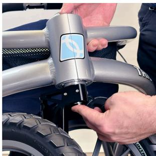
3. Fissare la sospensione della ruota anteriore alla parte inferiore e frontale del telaio nella stessa maniera, ovvero premendo il pulsante nero in fondo all'asse e spingendo l'asse all'interno del suo alloggiamento partendo dal basso. Rilasciare il pulsante.
