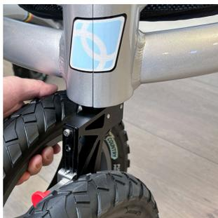
Per installare il sistema di sospensione della ruota anteriore prima di tutto sollevare la parte anteriore del telaio e poi, tenendo premuto il pulsante nero, spingere l'asse della ruota nel suo spazio di alloggiamento posizionato al di sotto del telaio. Rilasciare il pulsante nero.
