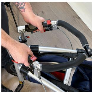
Sollevare e piegare simultaneamente le due metà del telaio avvicinandole l'una verso l'altra per chiudere completamente il Veloped.
